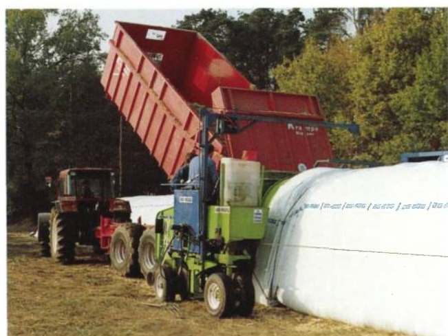
Die aus den USA stammende Variante der Preßschnitzelsilierung im Folienschlauch wird erfolgreich angewendet.
