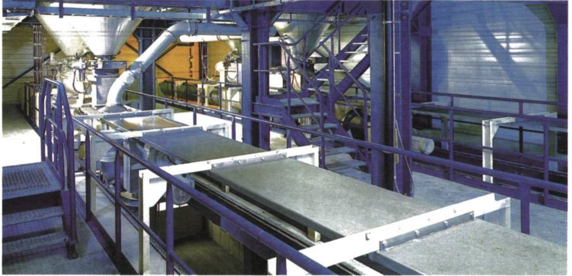
Neue Anlage zur Lose-Verladung von Zucker im Werk Ochsenfurt.
