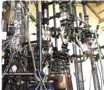
Miniplant-Anlage zur Optimierung des Verdampfungsprozesses in der Zuckerproduktion.
