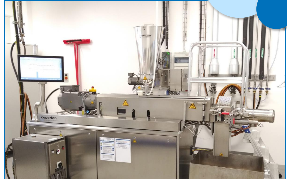
Herstellung von texturierten Proteinen im Pilotextruder für Fleischersatzprodukte in Offstein/Deutschland
